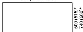
Перегородки фиксированной высоты для двухместных рабочих столов MOTION с двухстолбцовыми (H=600 мм) и трехстолбцовыми (H=740 мм) ножками
